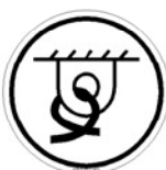
Fig. 5: Skilt for fastsurring til anslagspunkterne
