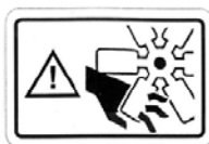
Fig. 18: Fare som følge af ventilatorens rotation!
